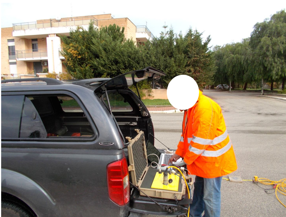
Acquisizione dati misure sismiche
