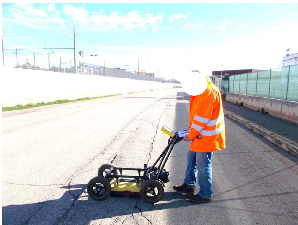
Sistema radar "NOGGIN 250" della Sensors & Software Inc.
