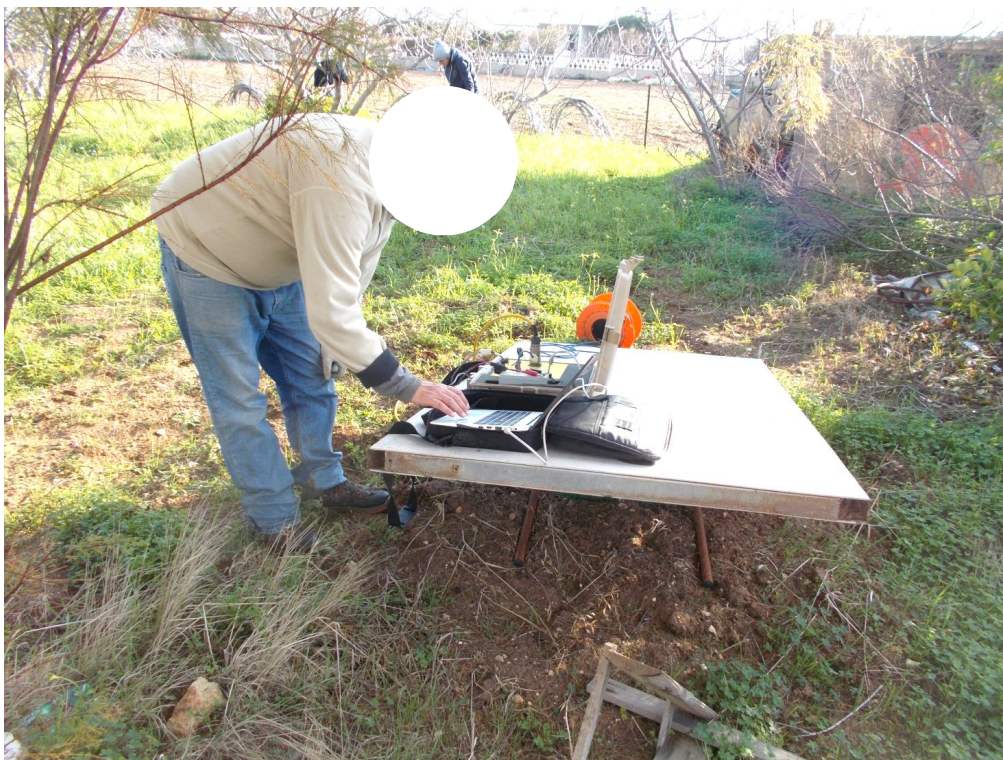
Acquisizione dati misure sismiche
