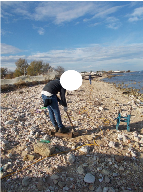
Energizzazione con mazza battente onde trasversali (onde SH)
