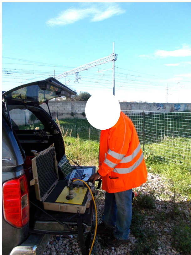
Acquisizione dati misure sismiche
