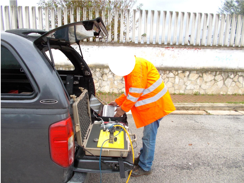
Acquisizione dati misure sismiche
