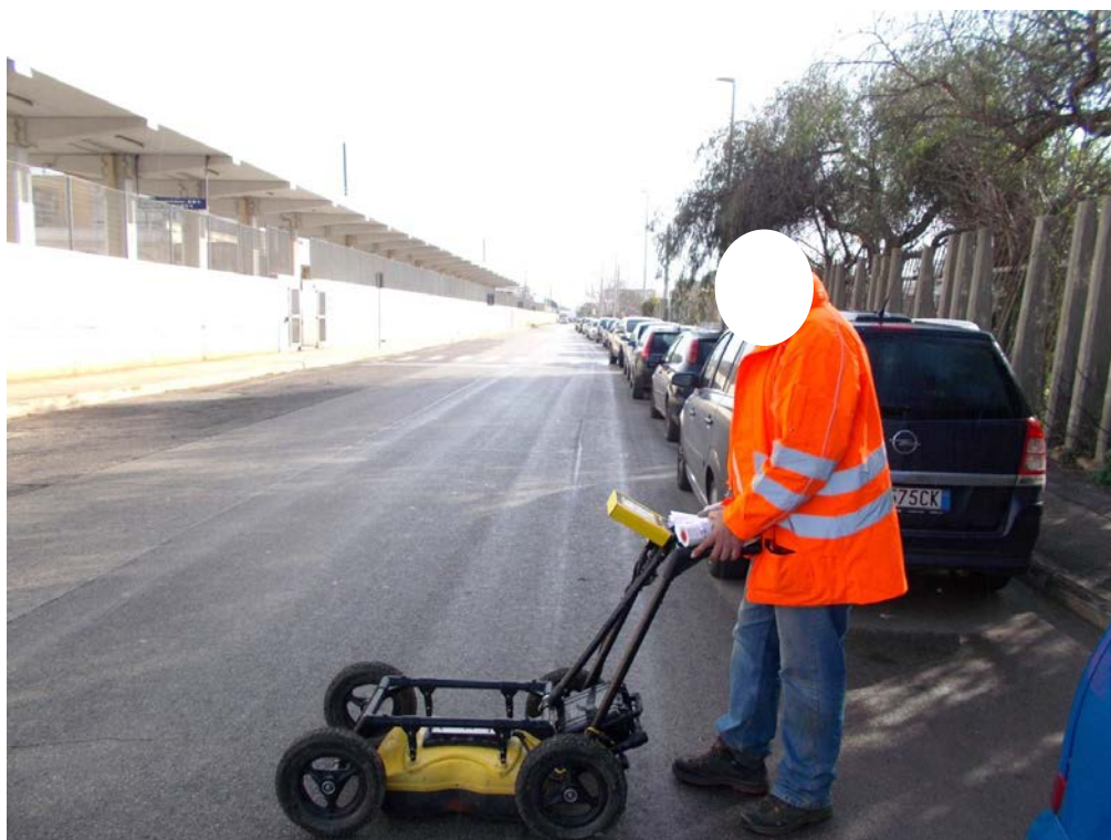
Sistema radar "NOGGIN 250" della Sensors & Software Inc.
