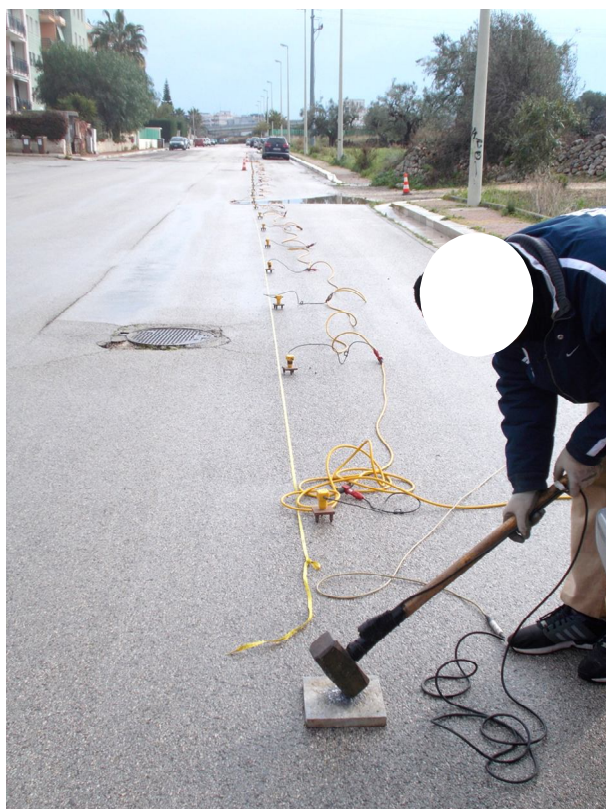
Energizzazione con mazza battente onde longitudinali (onde P)
