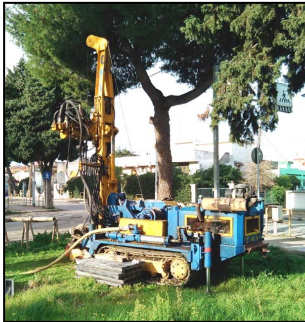
Trivella utilizzata (modello 530 della CMV)
